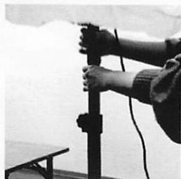
⑥高さ調節ネジを緩めて高さを調節し、任意の高さでネジを締めて固定します
